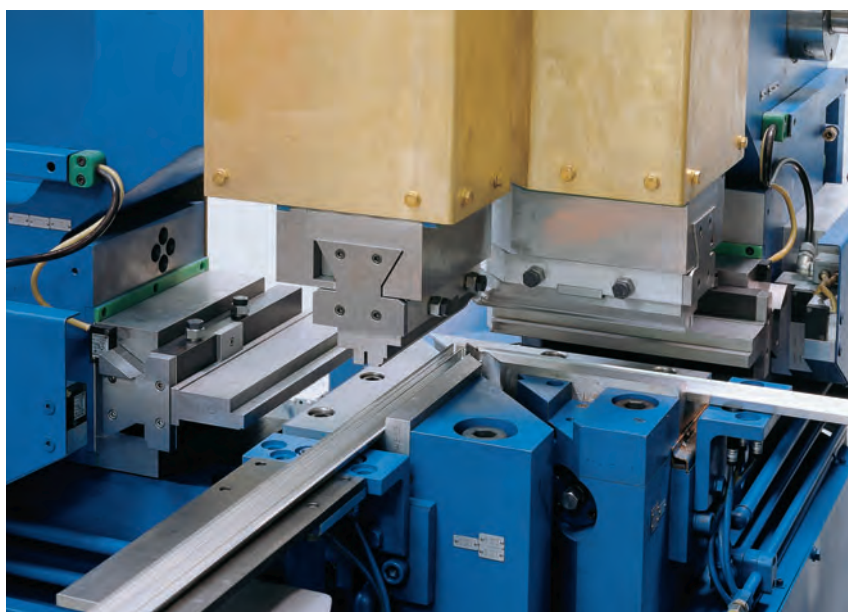
Сварка угловых стыков алюминиевых рам
