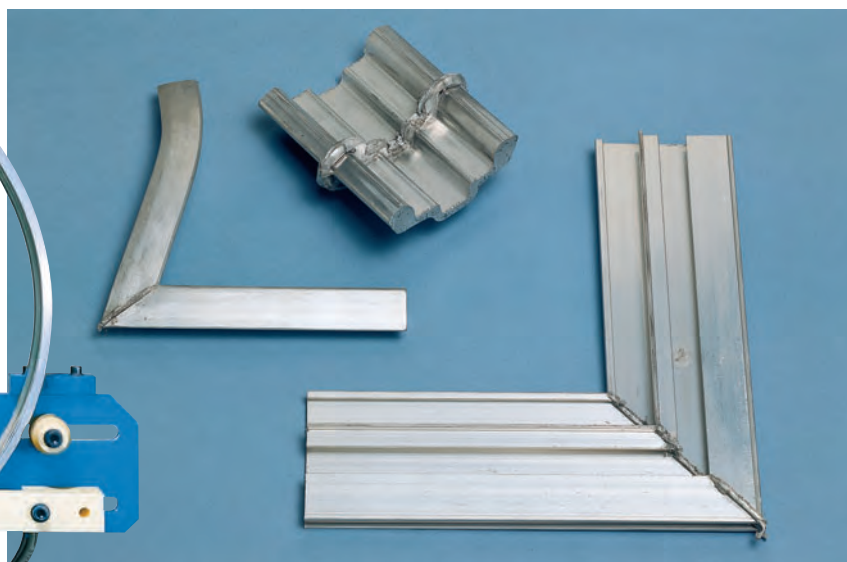
Сварка алюминиевых профилей (ободьев, сварка угловых стыков каркасов автомобилей и фасадов)
